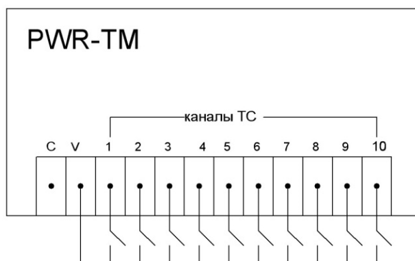
Рисунок 8 - Схема включения дискретных входов с использованием встроенного источника питания 24 В
